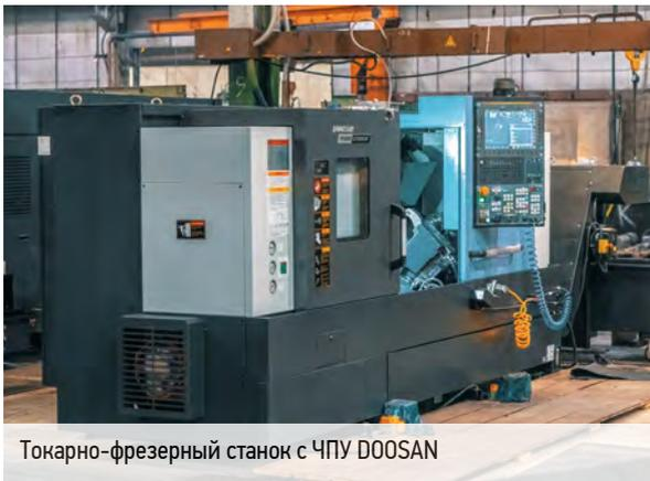
Токарно-фрезерный станок с ЧПУ DOOSAN
