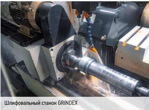
Шлифовальный станок GRINDEX
