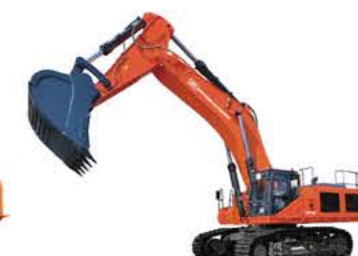
Экскаватор Профессионал RB950 Эксплуатационная масса 93,5 т Стандартный ковш 5,5 м³ Двигатель VOLVO PENTA TAD1643VE-B Номинальная мощность 565 кВт
