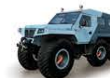
Хаски Грузоподъемность 2000 кг, Мест 8, Шины 1600x700-635
