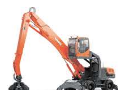
Экскаваторы-перезарядители E 230 MH: 23,4 т, ЯМЗ 534, 132 кВт
