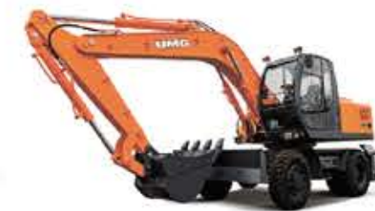
Колесные экскаваторы E 170W: 17,5 т, ЯМЗ 534/93, 88 кВт, 1,0 м³ E 185W: 17 т, Я 245, 77 кВт, 1,0 м³ E 200W: 18,5 т, ЯМЗ 534/29, 119 кВт, 1,0 м³
