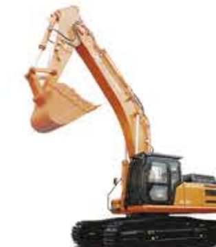
Экскаватор Профессионал RB400 Эксплуатационная масса 39,3 т Ковш скальный 1,9 м³ Двигатель Isuzu 6N-6NK1/ DCEC Cummins 6L89-C325 (Tier 2) Номинальная мощность 212/241 кВт
