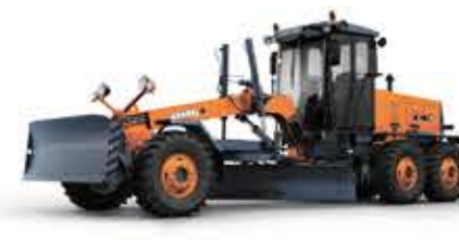
Автогрейдеры ГТ 14,02: 13,5 т, ЯМЗ 236 Г6, 110 кВт, 1x2x3 АГ 14,0: 14,5 т, ЯМЗ-236Г-16, 110 кВт, 1x2x3 АГ 180: 16,9 т, ЯМЗ-236М2-73, 132 кВт, 1x2x3 ДЗ 250: 19,7 т, ЯМЗ-238МД3, 173 кВт, 1x3x3
