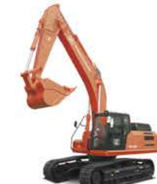
Экскаватор Профессионал RB330 Эксплуатационная масса 32,8 т Ковш скальный 1,6 м³ Двигатель Isuzu 6N-6NK1/ DCEC Cummins 6L89-C325 (Tier 2) Номинальная мощность 212/241 кВт
