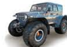
39041 Грузоподъемность 450 кг, Мест 5, Шины 1300x600-533
