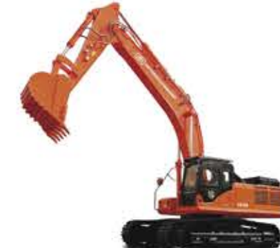
Экскаватор Профессионал RB500 Эксплуатационная масса 50,5 т Ковш скальный 2,6 м³ Двигатель Isuzu 6W61-XDHAG-03-C3 Номинальная мощность 300 кВт
