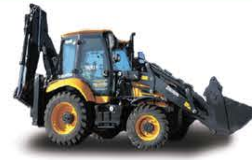
Cukurova 880S 8,1 т, Perkins 74,5 кВт, 4WD, Мех. КПП
