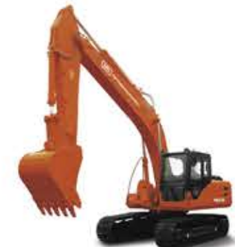
Экскаватор Профессионал RB225 Эксплуатационная масса 21,8 т Стандартный ковш 1,2 м³ Двигатель Cummins 6BTA459-C150 Номинальная мощность 112 кВт
