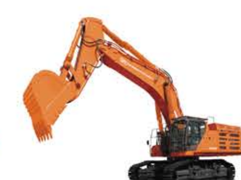
Экскаватор Профессионал RB700 Эксплуатационная масса 69 т Ковш скальный 4,4 м³ Двигатель WPI5H Номинальная мощность 566 кВт
