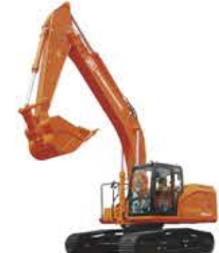
Экскаватор Профессионал RB245 Эксплуатационная масса 25,8 т Ковш скальный 1,3 м³ Двигатель Cummins QSB67-C190-31 Номинальная мощность 145 кВт
